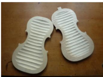
**5)** Ausarbeiten der Innenwölbung, ff-Löcher schneiden und Bassbalken einpassen, nach beliebiger Methode.
