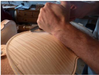
**9)** Hohlkehle bis ganz nach außen stechen (evt. einige 1/10 mm stehen lassen) und gleichzeitig die Überstände der Einlage egalisieren. Anschließend die Übergänge zur Wölbung verarbeiten und Wölbung putzen. Wieder kann bis raus geputzt werden (siehe Punkt 4) Man muss keine Angst vor kleinen Randverletzungen haben, da diese später weg fallen, wenn die Ränder reduziert werden.
