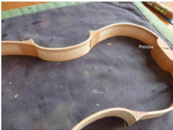
**1)** Der fertige, auf beiden Seiten mit Futterleisten bestückte Zargenkranz wird auf Boden und Decke übertragen + der gewünschte Randüberstand; ich benutze zunächst 3,5mm zum Aussägen (fertig 2,5mm).
