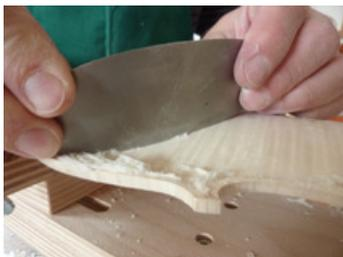
**4)** Wölbung mit vorläufiger Hohlkehle verbinden und fertig machen. Dies ist zunächst etwas gewöhnungsbedürftig, da Umriss, Einlage usw. noch fehlen, aber nach 2-3 Wölbungen hat es bei mir sehr gut funktioniert. Es gibt außerdem eine neue Sicht der Wölbung, die ohne große Mühe mehr denen der Klassiker ähnelt.
