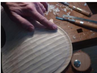
Für die Hohlkehlen in den Außenbögen benutze ich ein altes englisches Hohleisen von 25mm Breite und einer 6er Rundung, für die Mittelbüge 12mm Breite, gleiche Rundung (Angaben für Strad-Modell; die hier gezeigten Bilder sind von einem Guarneri-Modell mit engeren Radien!).
