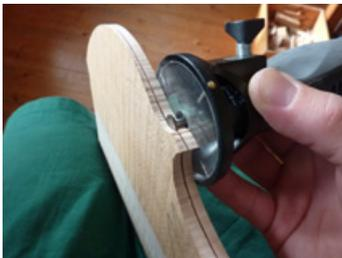
**2)** Randstärke auf Endstärke der fertigen Ecken und Zäpfchen bringen, ich benutze sehr gerne eine kleine Säge dazu, die durch ihre kleine Auflagefläche sehr handlich und präzise einzusetzen ist. Die Stärke ist abhängig von der späteren Hohlkehltiefe und dem verwendeten Radius des Werkzeuges, bei mir funktionieren 4,7mm sehr gut.
